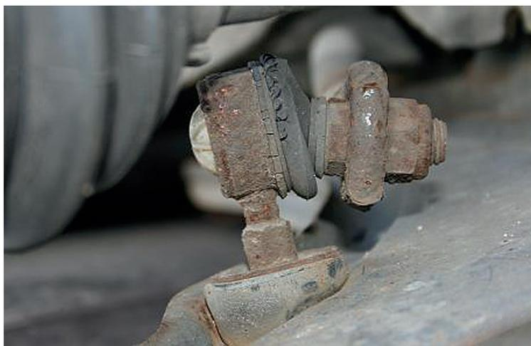
Si no se asegura una unión correcta entre la varilla estabilizadora y la barra estabilizadora, la maniobrabilidad del vehículo se deteriora considerablemente y puede dar lugar a un mayor movimiento basculante de la carrocería.
