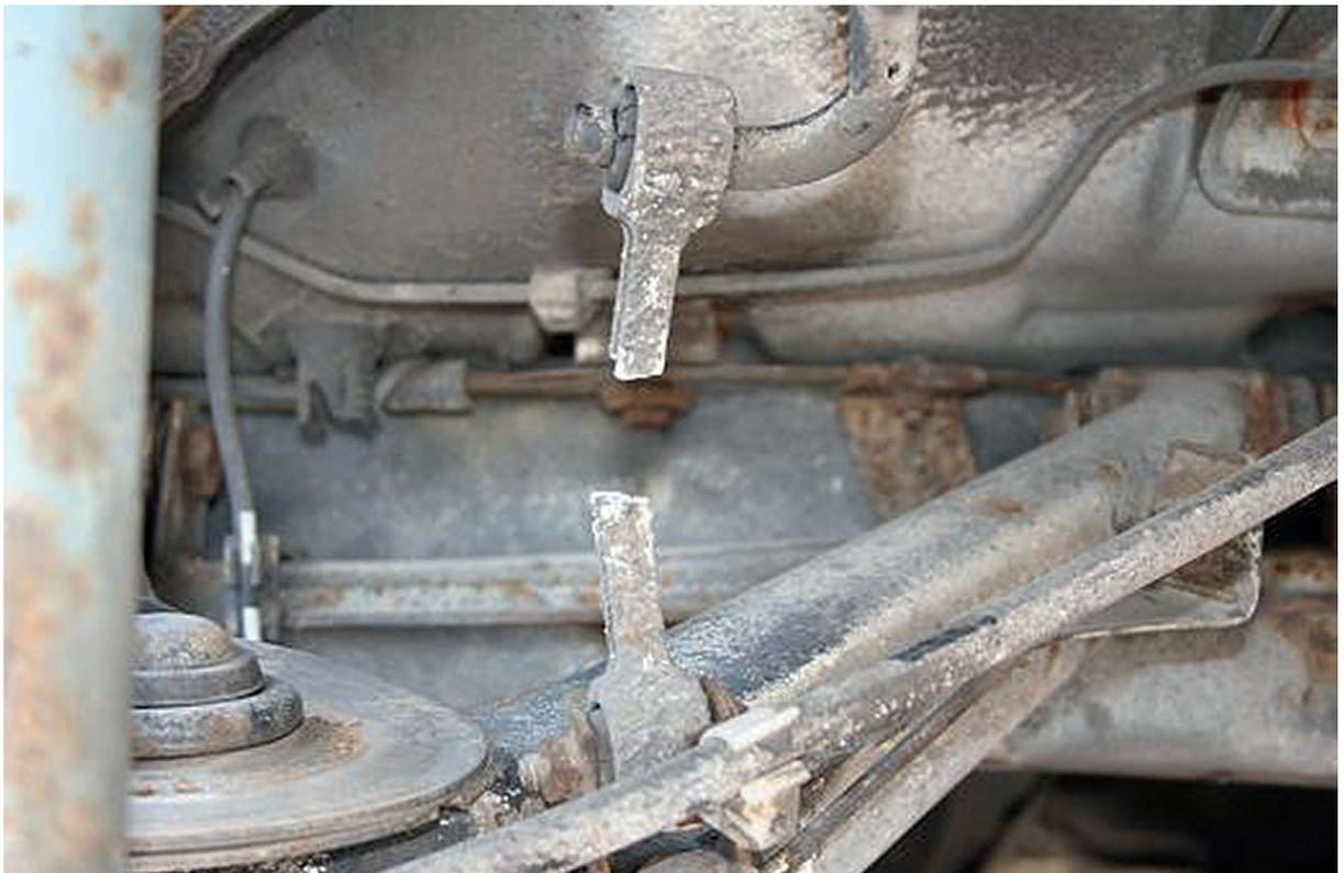
Se ejerce una tensión especial en las varillas estabilizadoras y los soportes de la barra estabilizadora en vehículos de suspensiones rebajadas o con muelles de suspensión rotos.
