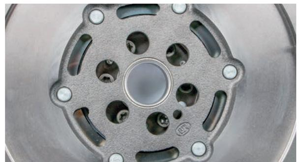
Si les alésages sont décalés par rapport aux vis, il est possible que le volant bimasse soit déjà endommagé. Dans ce cas, il est conseillé de procéder à un contrôle approfondi en utilisant l'outillage spécial LuK, réf. 400 0080 10.
