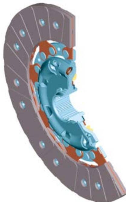
Fig. 26 c: Conception du disque d'embrayage avec compensation automatique de désaxage
