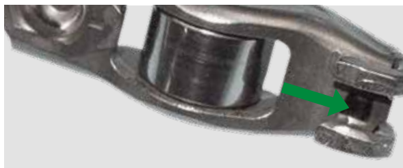
DESGASTE EN LA CARA DE CONTACTO DE LA VÁLVULA DE LA PALANCA OSCILANTE
