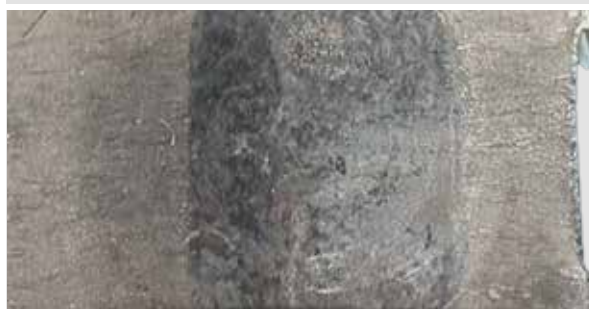
DESGASTE EN LA CARA DE CONTACTO DE LA VÁLVULA DE LA PALANCA OSCILANTE
