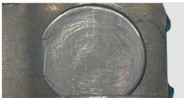
DESGASTE EN EL ANILLO EXTERIOR DEL RODILLO DE LEVAS
