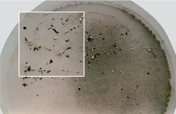
Bei der Überprüfung von reklamierten Teilen werden häufig Restschmutzpartikel in großer Menge gefunden. Diese Restschmutzpartikel, z. B. Aluminium, stammen von einer Zylinderkopfbearbeitung.
